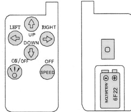
Stecken Sie den Stecker in eine Steckdose wie z.B. Zigarrettenanzünder und drücken auf "ON", wenn der Scheinwerfer aufgerichtet ist. Ist der Scheinwerfer zusammengeklappt dann drücken Sie auf die „UP“ Taste. Zum Ausschalten drücken Sie die "ON/OFF" Taste Im eingeschalteten Zustand drücken Sie die Tasten wie unten sichtbar zum Steuern der Lampe.
